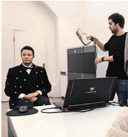
Um die Daten für die CNC-Maschine zu erfassen, wird der Tonkopf eingescannt. Für den Körper kommt ein Model zum Einsatz.
